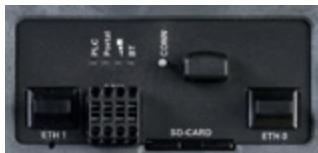
Smart Grid Interface CPU Modul 2 Ethernet-Port (100BASE-T), 1 serielle Schnittstelle RS232/RS485, 1 SD-Karten Einschub, 1 BT-Modem, WEB-PLC Programmierung
