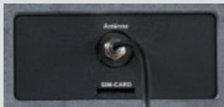
Smart Grid Interface Radio Modul, 1 UMTS-Modem, 1 Mini-SIM-Karten Einschub (2FF)
