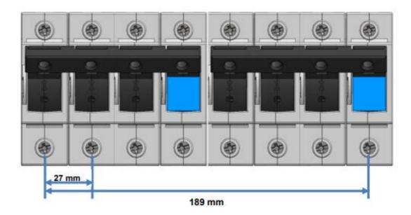
Die eingebaute Klemme mit einem Querschnitt von 1,5-35 mm² erlaubt den kombinierten Anschluss von Verschienungen bis 16 mm² und Leitungen mit Aderendhülsen bis 16 mm². Das Anzugsdrehmoment beträgt max. 4 Nm.
